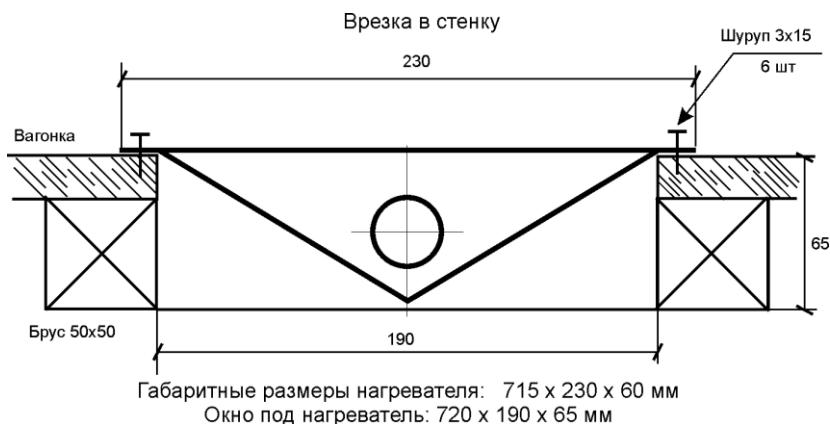
Рис.8 Установка тылового нагревателя (вид сверху)
